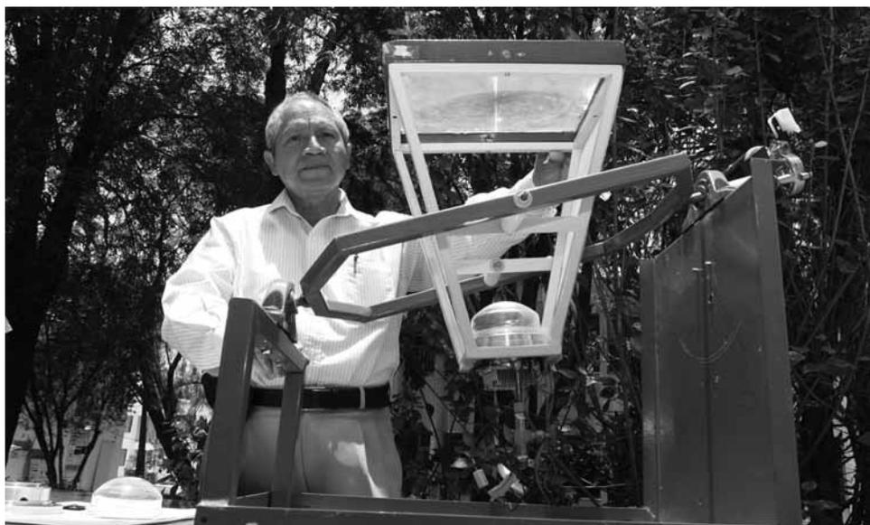
Científicos del Centro de Investigaciones en Dispositivos Semiconductores del Instituto de Ciencias (ICUAP) de la BUAP desarrollaron una celda termoeléctrica para radiación solar concentrada, que permitirá convertir de forma más eficiente el calor en energía.
