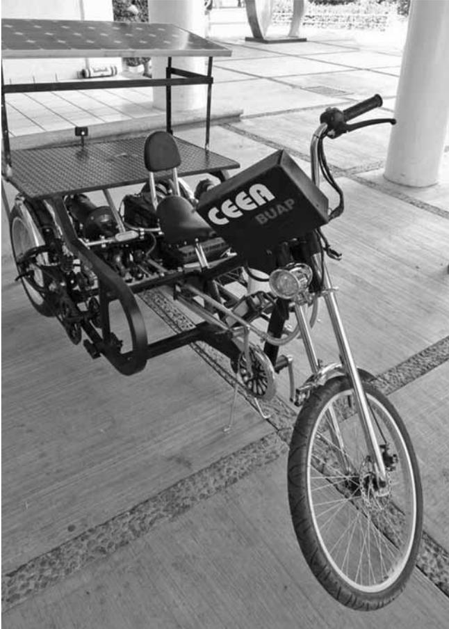
energía solar para mover al motor eléctrico. Tendrá una velocidad máxima de 30 kilómetros por hora, aunque puede alcanzar de 60 a 70 kilómetros en este tiempo, y puede llevar a tres personas.
