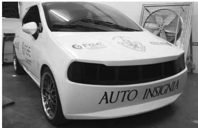
Se trata de un vehículo 100 por ciento ecológico, debido a que su motor obtiene la energía de un banco de baterías de 12 voltios conectadas en serie que generan corriente directa de 48 voltios. Además, se instalaron celdas fotovoltaicas en uno de los estacionamientos de la Facultad para recargar las baterías, con la idea de no usar ni combustible, ni energía convencional.
