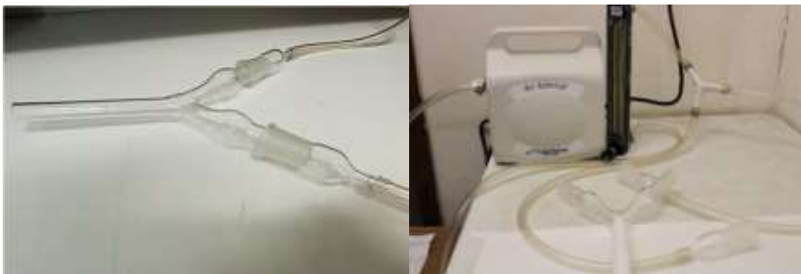
Figura 3. Instrumental y equipo, empleados para llevar a cabo bioensayos activos con adultos de diversas especies de Melolonthidae y vegetales. A) Detalle del olfatómetro en “Y” de dos vías, con brazo central y brazos complementarios con
